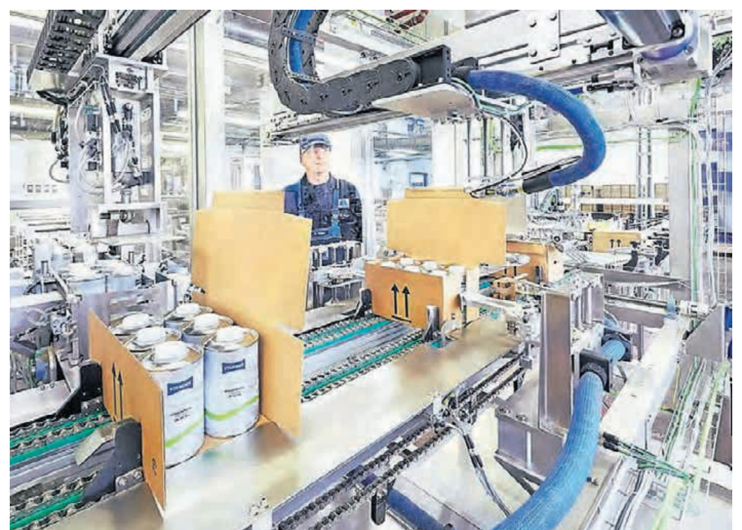
Schon früh wurden bei Herberts die Lacke maschinell in Dosen verpackt (oben). Heute übernehmen das bei Axalta vollautomatische Maschinen (unten).
