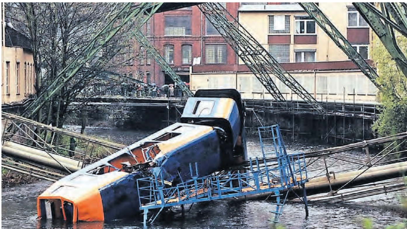
Dieses Bild machte ganz Deutschland auf Wuppertal aufmerksam: Nachdem Bauarbeiter während des Umbaus eine Kralle vergessen hatten, stürzte die Schwebebahn 1999 nahe des Robert-Daum-Platzes in die Wupper. Fünf Menschen starben, weitere wurden verletzt.
