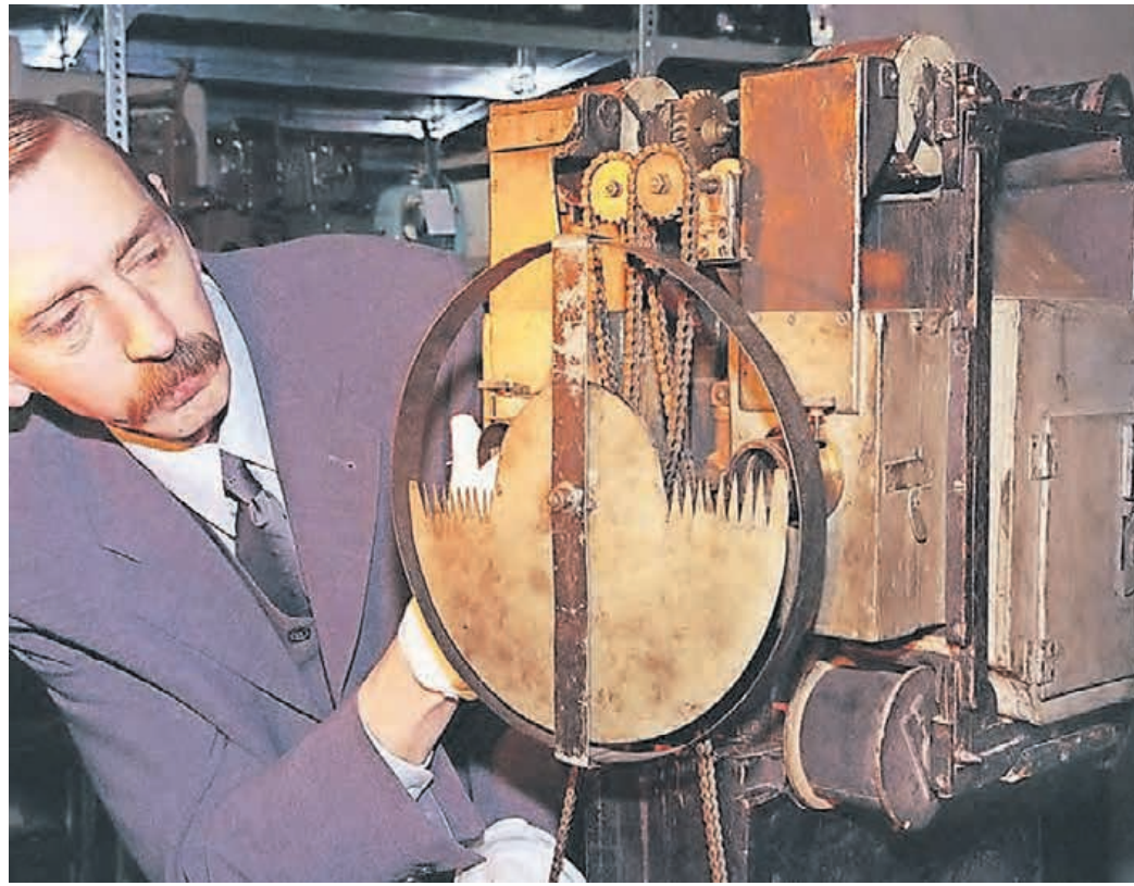
Mit so einem Filmprojektor dürften 1896 in Elberfeld die Filme gezeigt worden sein - Christian Ilgner, Sammlungsleiter für Technik im Filmarchiv Potsdam, präsentiert das „Bioskop“, mit dem Filme wie „Das boxende Känguruh“ vorgeführt wurden. Foto: dpa
