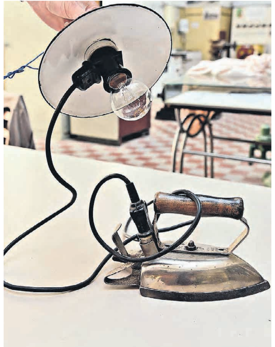
Die Anfänge der Stromnutzung: An der Deckenlampe befand sich eine Steckdose, in die die Hausfrau ihr Bügeleisen einstecken konnte. Der Vorteil: Bügeln mit gleichmäßiger Wärme und ohne Kohlenstaub.
