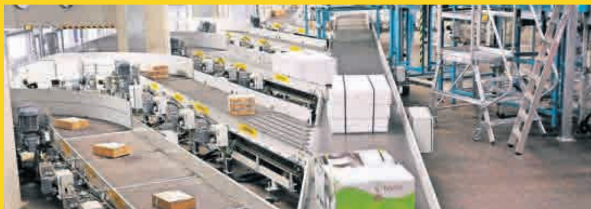
Das Paketzentrum ist von voll automatisierten Fließbändern durchzogen: insgesamt sind sie drei Kilometer lang.
